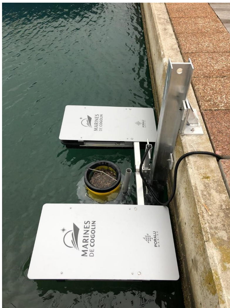
Figur 6 Seabin monterad på kaj med flytande pontoner på respektive sida om fästanordningen (Bildkälla: Nicholas Eriksson, 2019)
