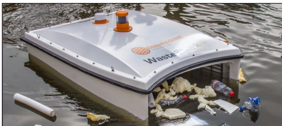
Figur 7 Den skräpätande, vattenburna roboten WasteShark. (Bildkälla: RanMarine, 2019)
