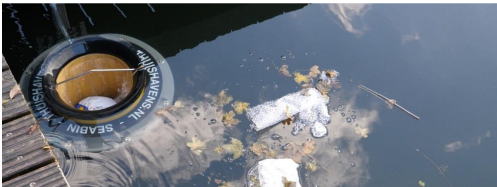
Figur 3 En Seabin med oljepod installerad vid en brygga. (Bildkälla: The Seabin Project, 2019)
